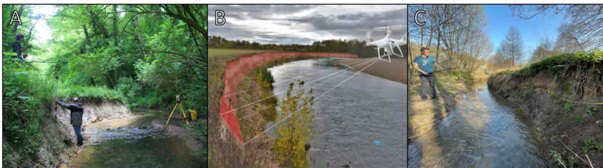
Figure 2. Photographies des différents protocoles d'acquisition. A : Photogrammétrie SfM pédestre sur la Mérantaise. B : Photogrammétrie SfM par drone RTK sur l'Armançon. C : Acquisition LiDAR sur le Morbras.
