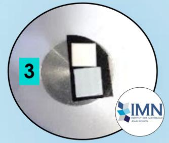
3 Enfin, elle est coupée, montée sur un plot et métallisée (1 à 5 nm de platine)
