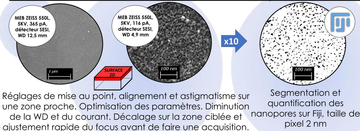
Réglages de mise au point, alignement et astigmatisme sur une zone proche. Optimisation des paramètres. Diminution de la WD et du courant. Décalage sur la zone ciblée et ajustement rapide du focus avant de faire une acquisition.
