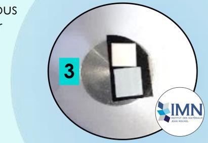
3 Enfin, elle est coupée, montée sur un plot et métallisée (1 à 5 nm de platine)
