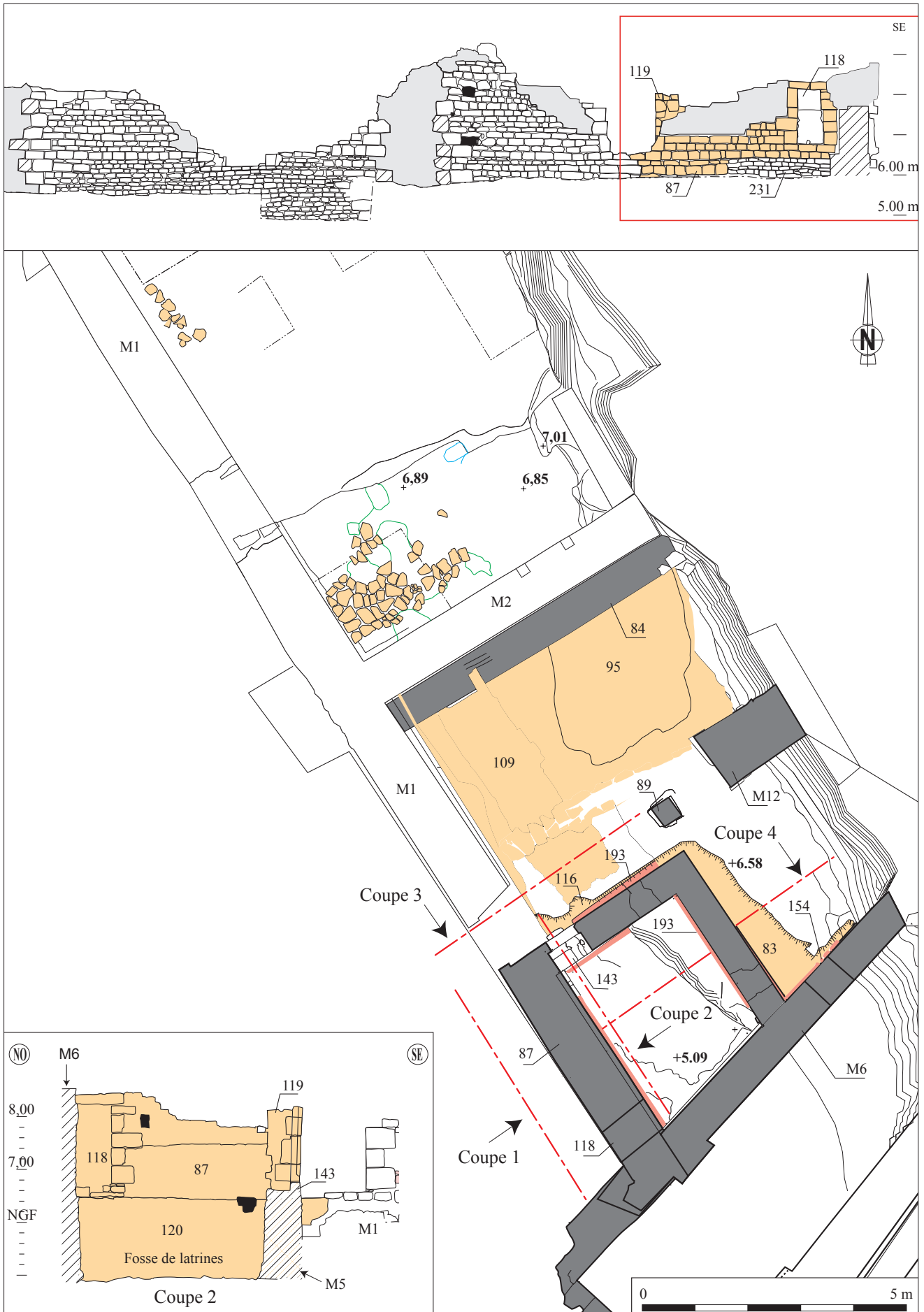
Fig. 61 : plan, élévations intérieures et extérieures des latrines
