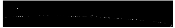
(b) Seuillage simple à 75 : des pixels de l'atmosphère sont détectés et génèrent 184 régions.
