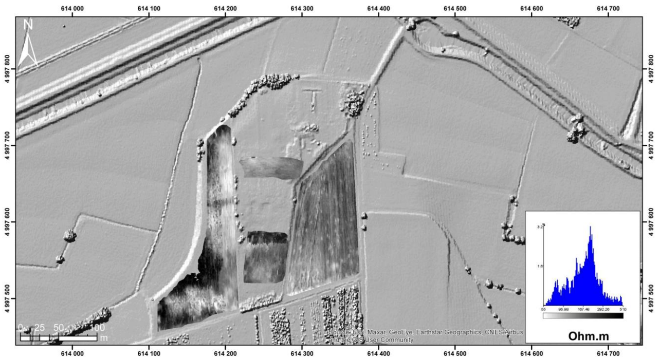
Fig. 8. 1. Mappa della resistività apparente su base LIDAR, profondità di indagine 0 - 100 cm, scala 55-400 ohm.m; 2. profondità di indagine 0 - 170 cm, scala 55-510 ohm.m (base Geoportale Nazionale, elaborazione Geocarta).
