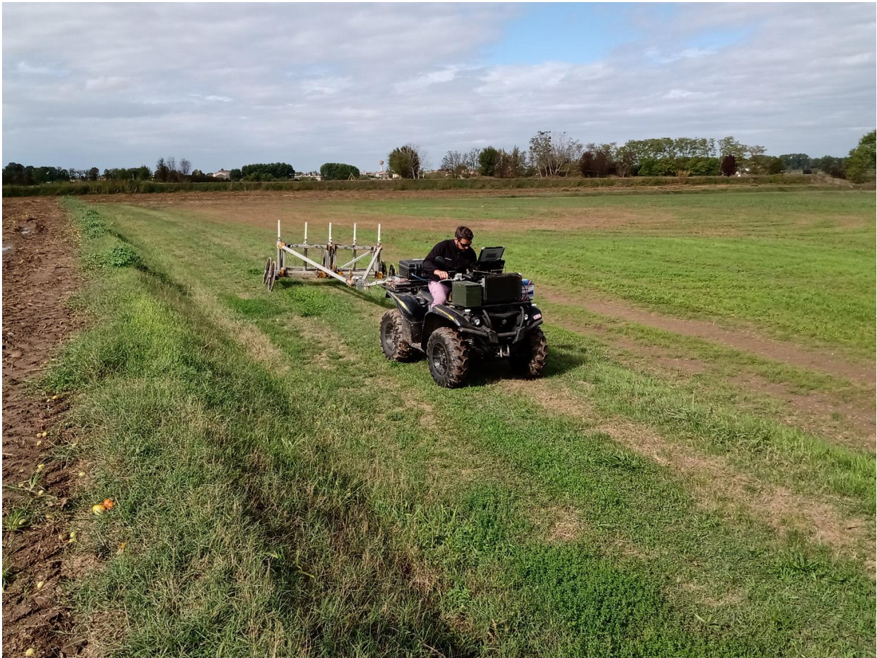
Fig. 5. Le prospezioni geofisiche del 2021 in corso nel Campo del Generale. L'operatore su quad trainante i sensori per l'analisi AMP (foto L. Zamboni, da est).
