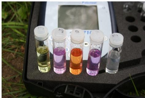
**Spectrophotomètre de terrain et tubes avec réactifs pour la quantification du calcium (Ca), du magnésium (Mg), du potassium (K), des nitrates ( $\text{NO}_3^{2-}$ ), des sulfates ( $\text{SO}_4^{2-}$ ) et des phosphates ( $\text{PO}_4^{3-}$ ) directement sur site.**
