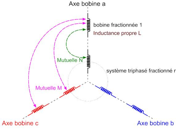
FIG. 1. Représentation schématique de la machine électrique fractionnée
