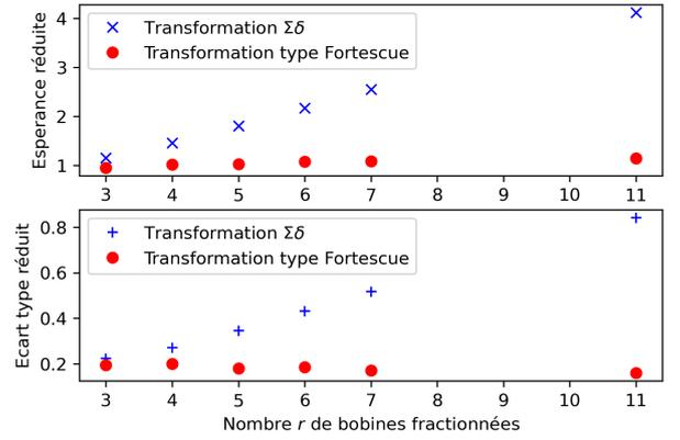
FIG. 4. Comparaison des espérances réduites  $\mathbb{E}[\hat{\delta}(\mathcal{P}_{\mathcal{T}_x})]/\frac{\alpha}{\sigma}$  et des écarts types réduits  $\mathbb{S}[\hat{\delta}(\mathcal{P}_{\mathcal{T}_x})]/\frac{\alpha}{\sigma}$  pour les deux transformations proposées et pour différentes configurations de fractionnement.
