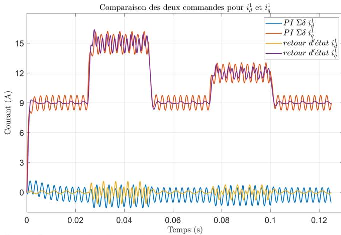
FIG. 9. Réponse indicielle pour l'axe  $i_q$
