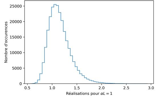
FIG. 3. Réalisations de la variable aléatoire  $\hat{\delta}(\mathcal{P}_{\mathcal{T}_x})$  pour un fractionnement en 3 sous bobines et  $2^{18}$  tirages indépendants et pour une transformation en mode commun / mode différentiel.
