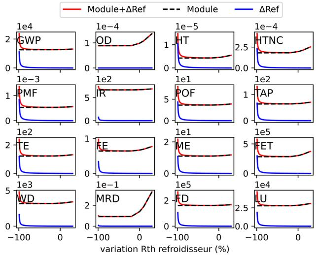
FIG. 13. Impact de la variation du  $R_{th}$  du refroidisseur sur les IE du module de puissance couplé à la variation des IE du refroidisseur. La courbe Module représente les IE à 30 ans du module de puissance (usage + fabrication/remplacement), la courbe  $\Delta Ref$  représente la variation des IE liés à la fabrication du refroidisseur et la courbe Module +  $\Delta Ref$  représente la somme des deux.
