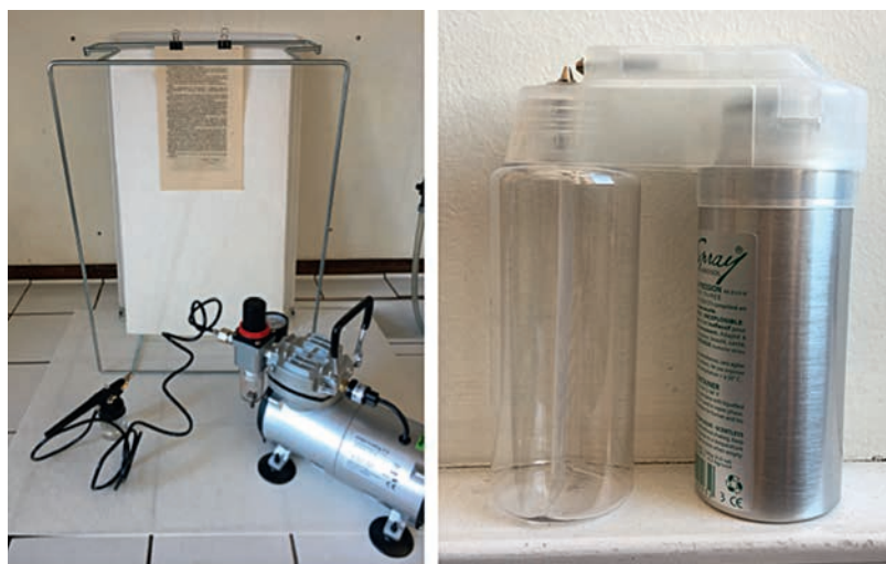
Figure 1. Aérographe (Vidal XL) à gauche et EcoSpray à droite utilisés pour appliquer les traitements par vaporisation sur les papiers.
