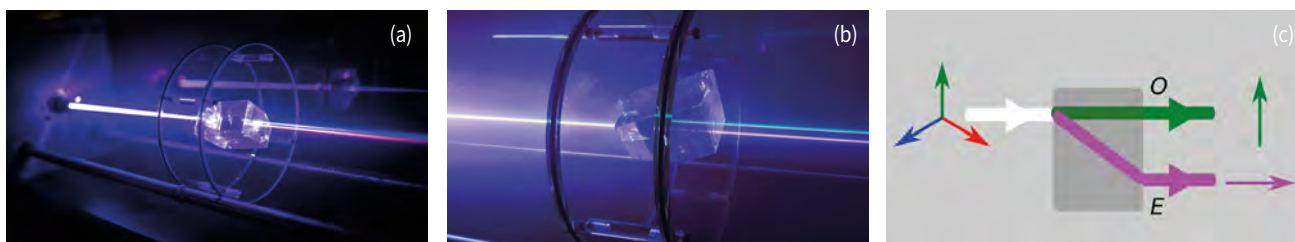
Figure 2. L'installation « Le Rayon extraordinaire » (a) donne l'illusion qu'un cristal de calcite colore un faisceau laser blanc incident pour former deux rayons aux couleurs complémentaires qui évoluent avec la rotation du cristal (b). Un effet de sélection polarimétrique est en réalité à l'œuvre dans ce phénomène en choisissant judicieusement les polarisations des trois lasers (RVB) combinés dans le faisceau blanc (c). (© G. Julien/Service Culture & J. Fade/Univ Rennes)
