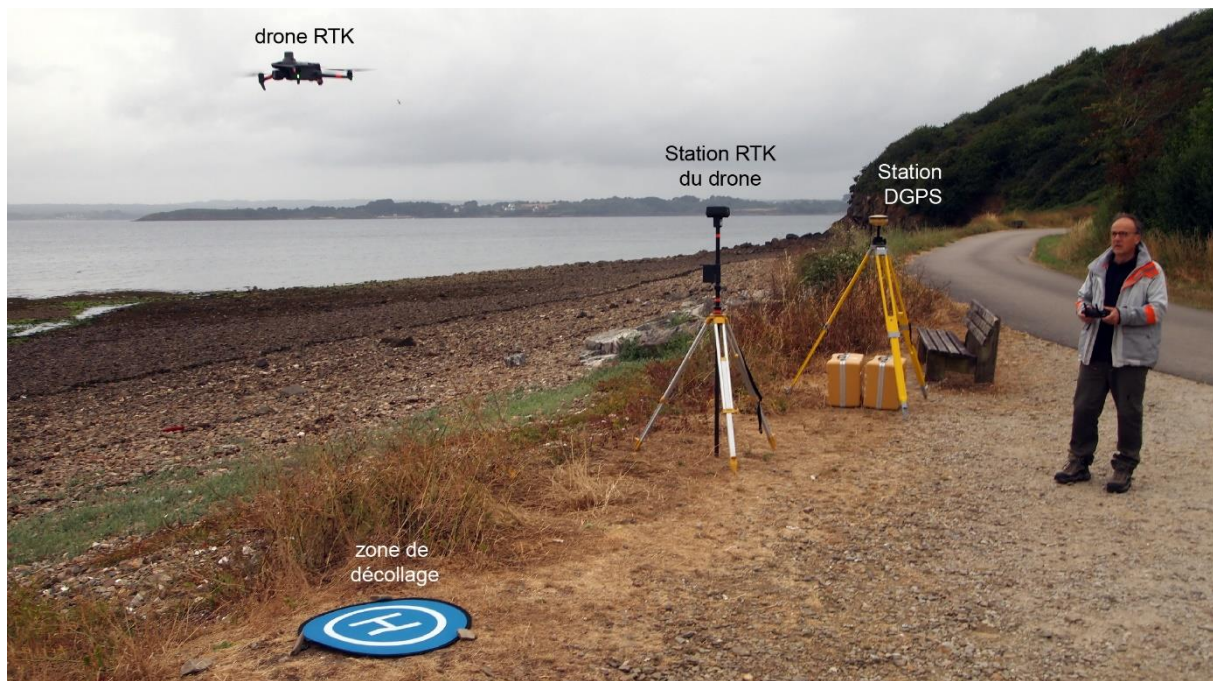
Figure 1 : Méthode de mesure de terrain basée sur l'acquisition d'images aériennes géoréférencées avec une précision centimétrique (drone RTK) et de mesures de cibles au sol au GPS différentiel.
