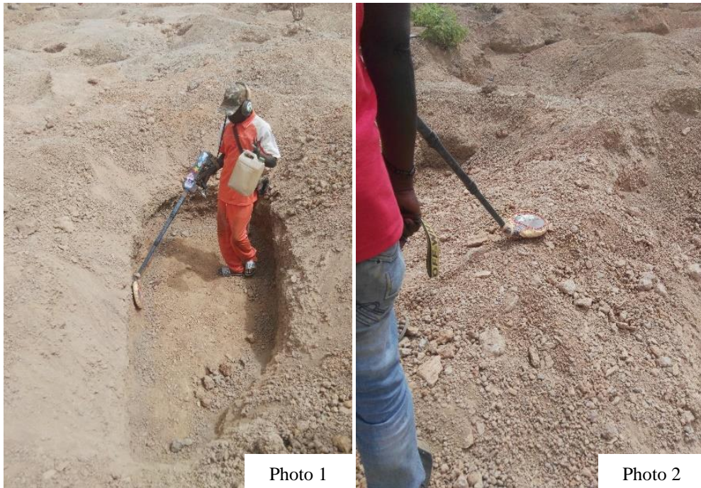
Planche 3 : illustration de l'usage du détecteur de métal
