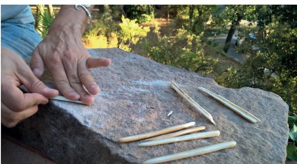
**Fig. 3** – Ponçage des baguettes sur meule de grès.
