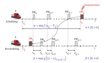
Fig. 4. Definition of parameters  $(\alpha, \beta)$
