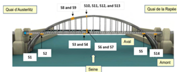
FIGURE 1 : Le viaduc d'Austerlitz, avec les capteurs déployés.
