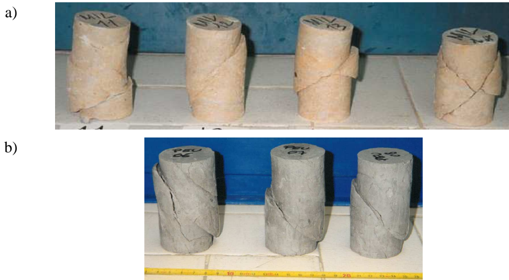
Figure 38 : Marnes fissurées. Eprouvettes triaxiales après essai et étuvage. Diamètre initial 50 mm.
