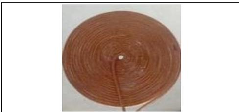
Fig.6. Bobine d'induction, diamètre 10 cm
