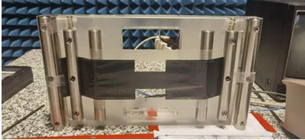
Fig.9. Banc de mesure : film tendu et alimenté par un courant continu (échauffement Joule).
