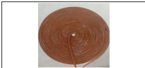
Fig.6. Bobine d'induction, diamètre 10 cm
