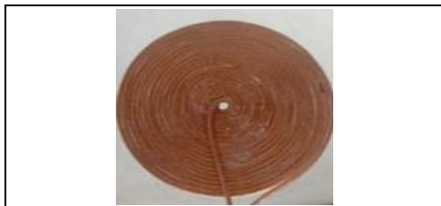
Fig.6. Bobine d'induction, diamètre 10 cm
