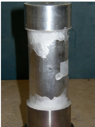
Figure C-3 : Photos du dispositif d'essai de fluage en compression uniaxiale. Six bâtis.
