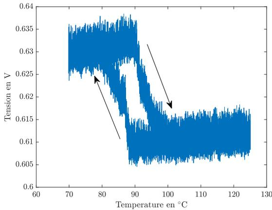
FIG. 3. Signal de la photodiode, proportionnel à la réflectivité, en fonction de la température pour un cycle  $70 \rightarrow 120 \rightarrow 70$  °C. On observe un cycle d'hystérésis thermique avec, à basse température, la phase AFM qui se caractérise par une réflectivité élevée (tension plus haute) et, à haute température, la phase FM qui se caractérise par une réflectivité plus faible (tension plus faible). Les flèches indiquent le sens dans lequel le cycle est parcouru.
