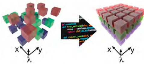
Figure 2 : Illustration de la reconstruction computationnelle de l'hyperspectre complet à partir de sa mesure sous-échantillonnée.
