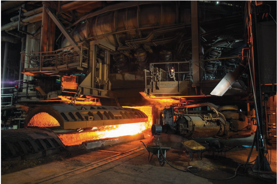
Plancher de coulée au haut fourneau.
