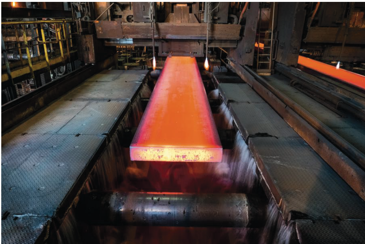
Des brames d'acier en sortie de coulée continue.
