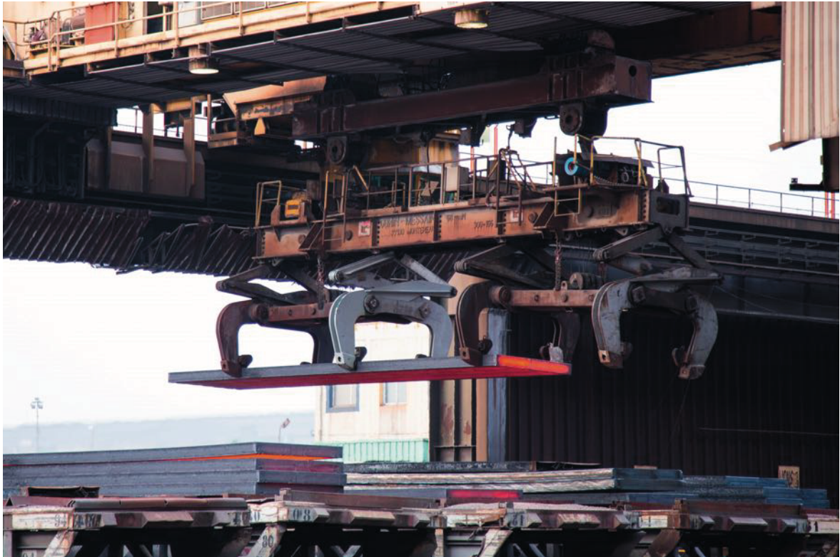
Manutention de brames en sortie de coulée continue.
