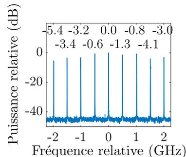
Figure 2. Spectre optique mesuré après optimisation manuelle.
