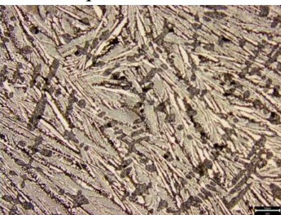
Figure 7 : microstructures de la fonte Fe-3,8C-2,5Cr-1,5Si à l'état brut (haut), après recuit de 5 minutes à 950°C (centre), et après recuit de 15 minutes à 950°C (bas) ; sans attaque (gauche), après attaque Nital (milieu), après attaque Nital+Klemm (droit)
