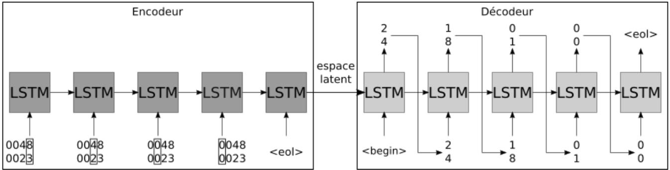
FIGURE 2 – Architecture *Seq2Seq*. L’encodeur reçoit successivement les deux chiffres (encadrés) de deux lignes consécutives (les opérands 23 et 48) de droite à gauche. À partir de l’encodage, le décodeur produit de façon récurrente les chiffres, de droite à gauche, des deux lignes suivantes (ici la retenue et le résultat de la première multiplication intermédiaire  $8 \times 23$ ). Dans la pratique, chaque chiffre est codé sous la forme d’un vecteur *one-hot*.
