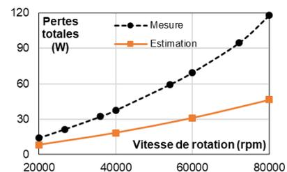
Fig. 3 Pertes totales à vide mesurées et estimées.
