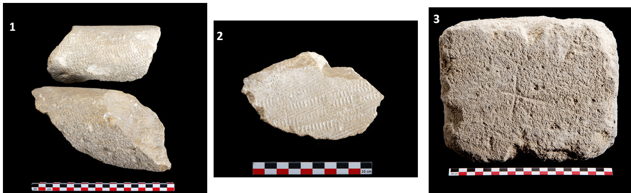
Fig. 42. US 2021, éléments lapidaires en calcaire : deux fragments de blocs moulurés (1) avec traces d'outil (marteau grain d'orge ?), 1 fragment de face dressée avec traces d'outil de type brettüre (brettelée oblique) (2) et un bloc de parement calcaire avec une face dressée et marque de tâcheron (3). Cliché : Marc Lelièvre, DHAAP.
