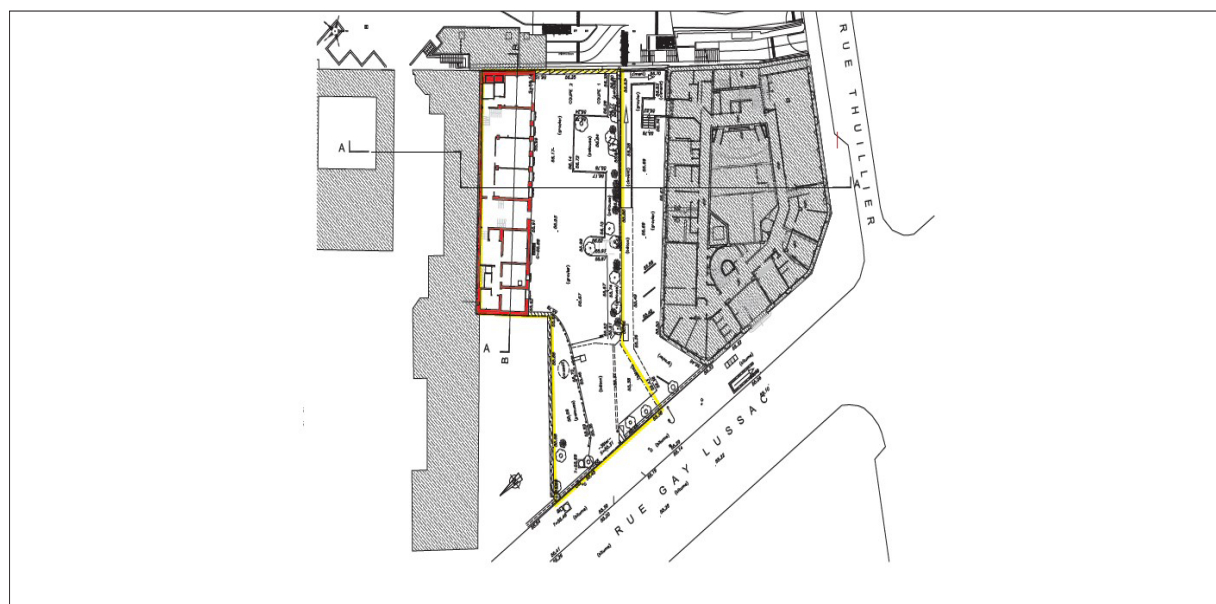
Figure 4 : plan de l'existant avec en rouge le bâtiment devant être démolit et en jaune l'emprise du projet
