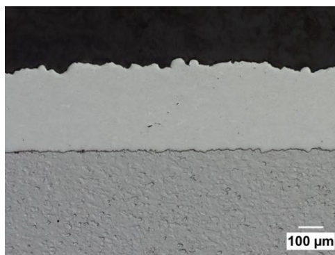
FIGURE 6 – Dépôt d'alliage d'aluminium obtenu par projection à froid sur substrat en acier
