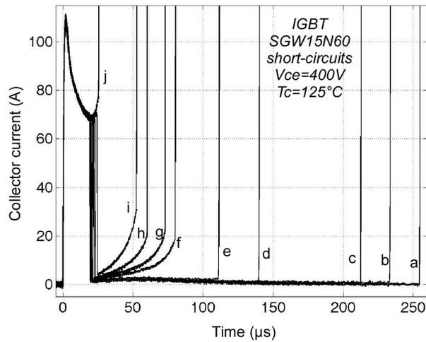
Fig. 3. Experimental short-circuit current waveforms for SGW15N60 devices under 400 V at  $125^{\circ}\text{C}$  and for different short-circuit durations  $t_{SC}$ : (a)  $19\mu\text{s}$ ; (b)  $19.2\mu\text{s}$  (d)  $19.5\mu\text{s}$ ; (e)  $20\mu\text{s}$ ; (f)  $20.5\mu\text{s}$ ; (g)  $21.5\mu\text{s}$ ; (h)  $22.5\mu\text{s}$ ; (i)  $24\mu\text{s}$ .
