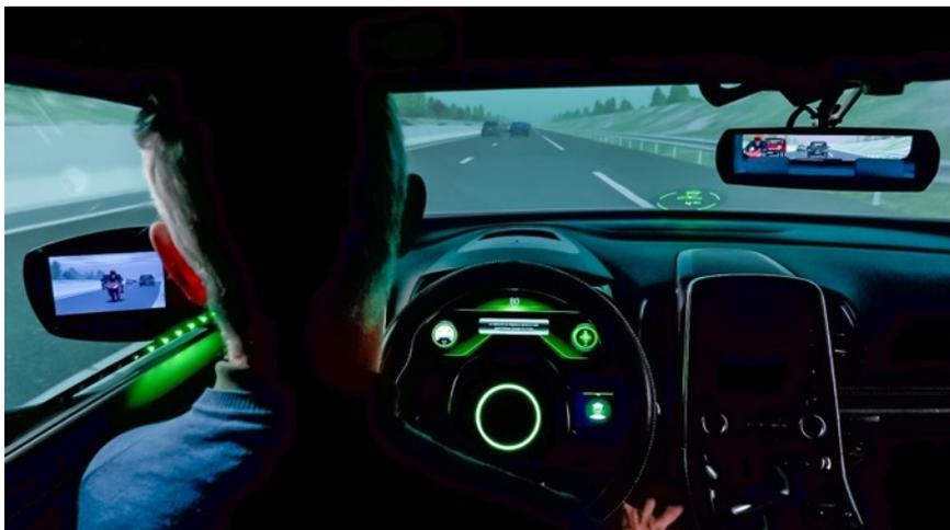
*Figure 4 : Pour Roberto, des LED dans le volant et l'affichage d'une icône dans le pare-brise indiquent que la conduite automatisée est active*
