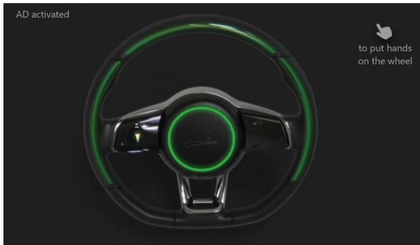
Figure 11 : Exemple d'illustration de l'animation des LED sur le volant en configuration Roberto\_CMI dans une situation de demande de reprise en main. La jante du volant se met à clignoter pour inciter le conducteur à repositionner ses mains sur le volant. A l'issue de cette action la jante s'éteint au profit des branches pour signifier au conducteur la bonne prise en considération de son action.
