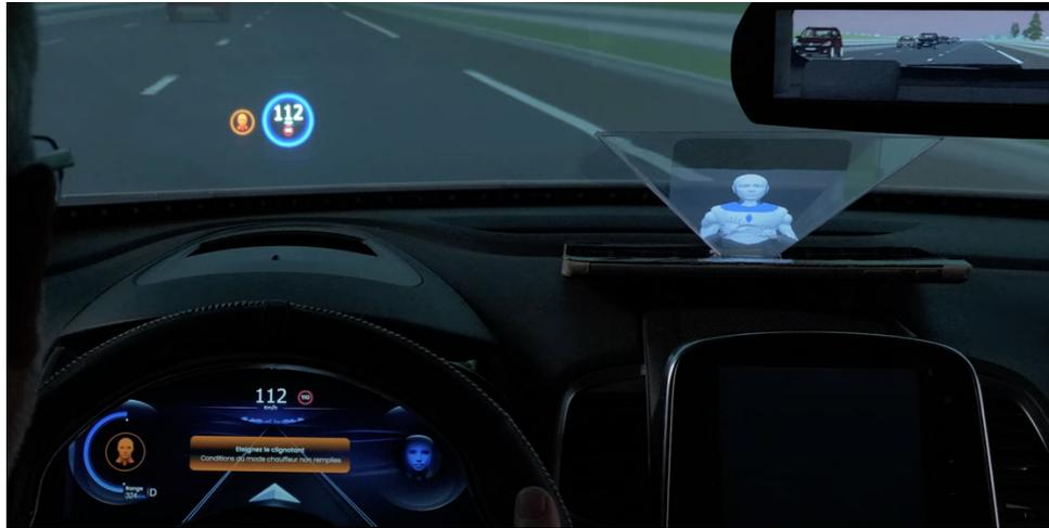
Figure 13 : Exemple de situation de guidage du conducteur à l'activation de l'AD. Dans cette situation, l'assistant apparait pour signaler au conducteur de retirer son clignotant avant de procéder à l'activation de l'AD.
