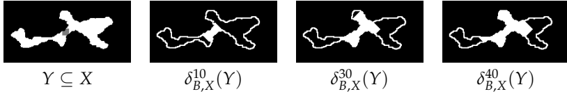
FIGURE 3.16 – Plusieurs itérations de la dilatation géodésique de Y (en gris dans l'image de gauche) dans X (en blanc), avec un élément structurant B en forme de croix (connexité 4).
