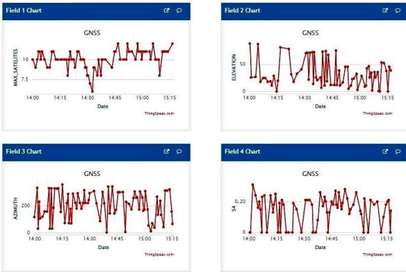
Fig. 5: Mostra os gráficos de S_4 (em uma escala de 0 a 1) Número Máximo de Satélites, Elevação, Azimute e S_4 , sobre o alvo ( -3^{\circ} 5' 34'' ; -60^{\circ} 2' 24'' ), em dois dias e horários diferentes.
