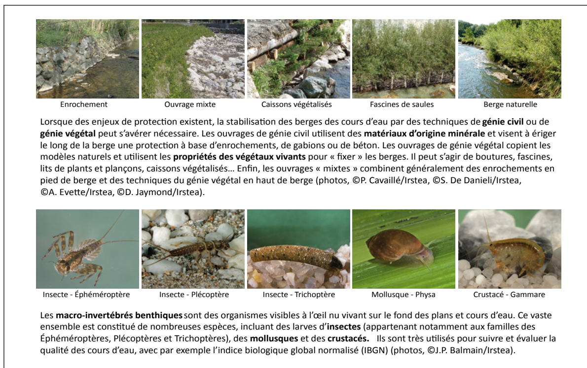
Figure 2. Illustrations et description des techniques d'ingénierie utilisées pour stabiliser les berges des cours d'eau et des principaux groupes taxinomiques de macro-invertébrés benthiques pris en compte dans cette étude
