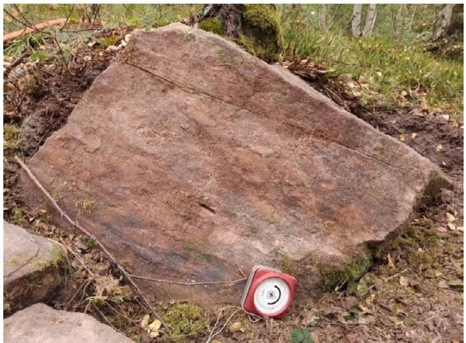
Fig. 18. Bloc portant un miroir de faille strié, correspondant à un cisaillement.
