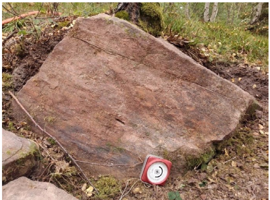
Fig. 18. Bloc portant un miroir de faille strié, correspondant à un cisaillement. Cliché : P. Elsass
