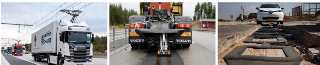
FIGURE 10 – Les trois technologies à l'étude pour l'électrification des autoroutes : caténaires, rail conducteur au sol, induction [53].
