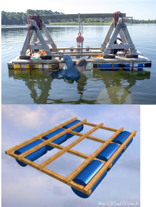
Figure 13 : Deux types de radeaux en bidon, en haut avec une chèvre sur potence (descente précise).
