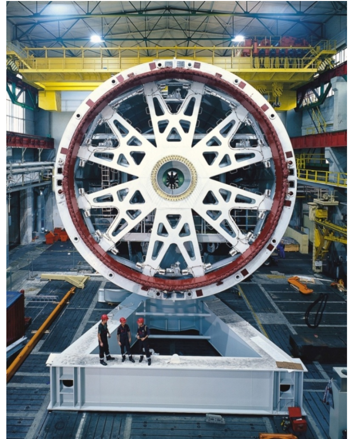
EESG in Enercon E-126- 7.5 MW
