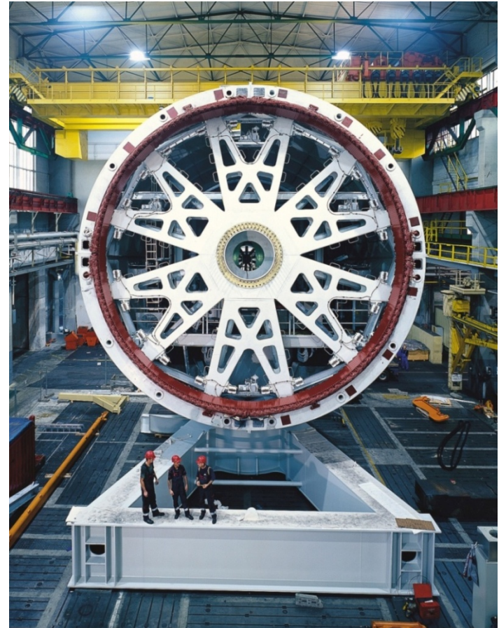
EESG in Enercon E-126- 7.5 MW
