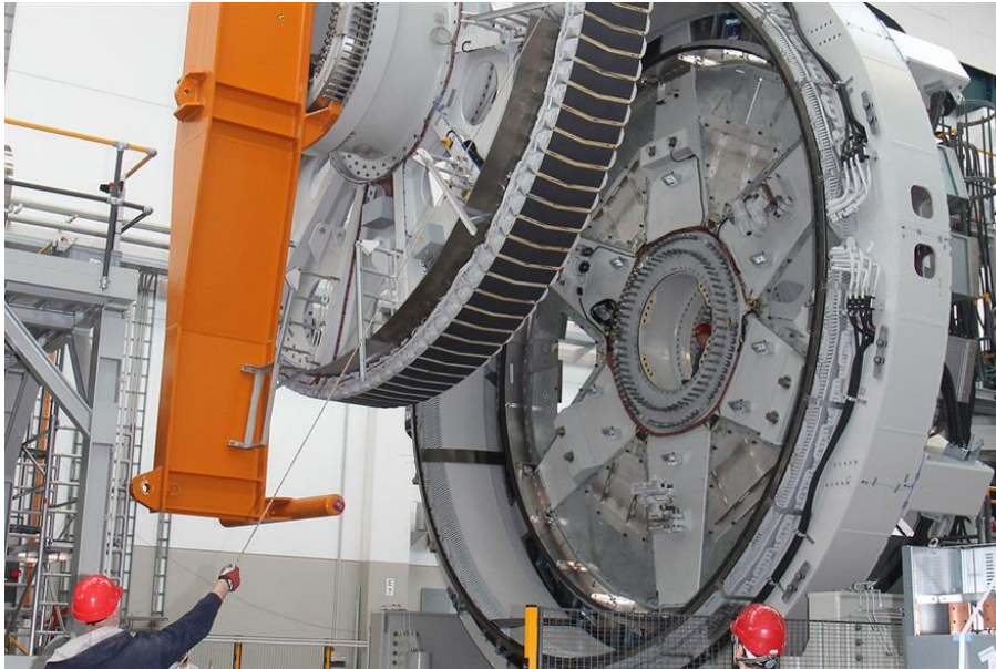
EESG in Enercon E-138 EP3 4.2 MW
