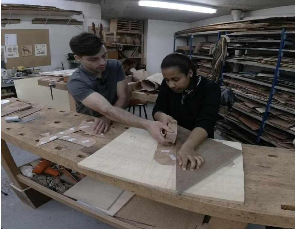
[Fig. 5] Photographies présentant un exemple de geste correctif avec intervention sur l'apprentie : face à un mauvais geste le formateur se rapproche, prend l'outil et le place correctement, CFA La Bonne Graine, 2018
