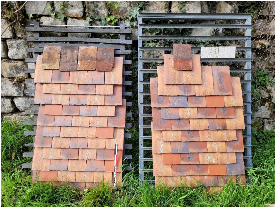
FIG. 98 : Disposition en imbrication des tuiles neuves dans le projet de restauration de la couverture de la chapelle (Etienne Courné).
