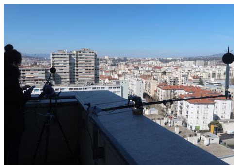
Captations et mesures acoustiques, gratte-ciel de Morice Leroux à Villeurbanne, photographie LASA.
