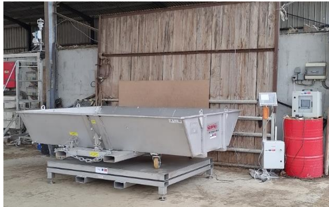
Figure 3: Système de pesée, benne basculante et station météo sur site (GAEC des Vallons)
