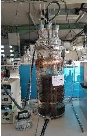
Figure 2: Réacteur VSD de laboratoire de 5 litres (LBE)
