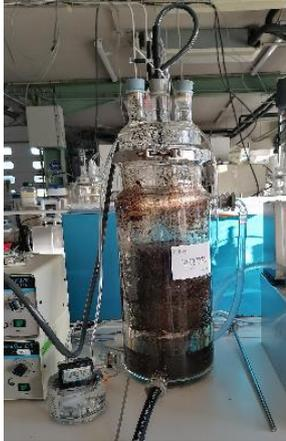
Figure 2: Réacteur VSD de laboratoire de 5 litres (LBE)
