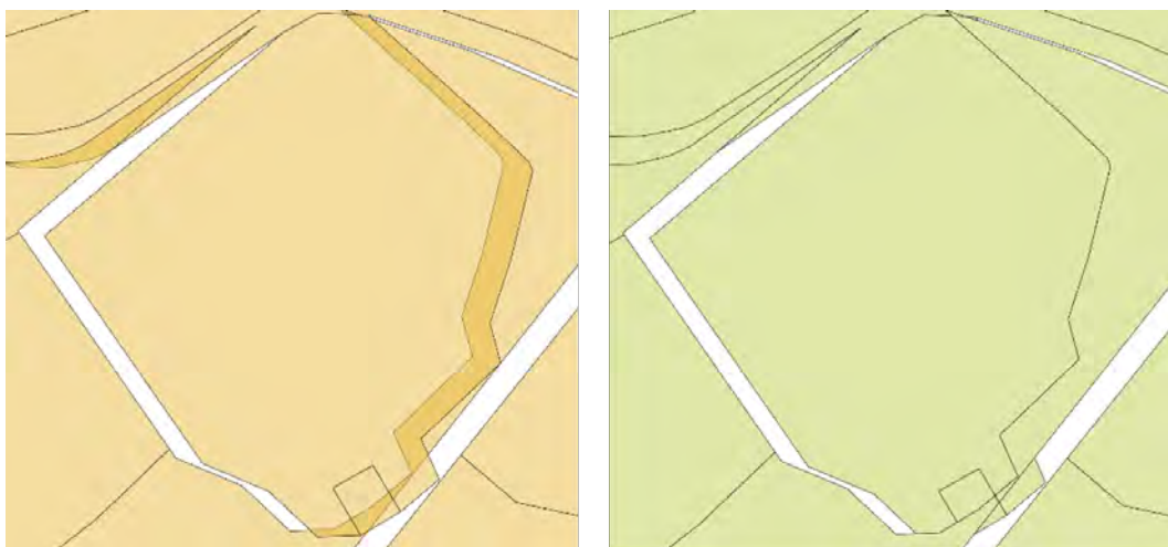
FIGURE 11.18 – Correction des erreurs topologiques de superposition de parcelles
