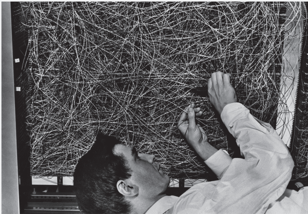
Fig.1 - Un ingénieur du Corneil Analytical Laboratory travaille sur le réseau de neurones arFils Perceptron développé par Fritts Rosenblatt, Buffalo, circa 1960.
